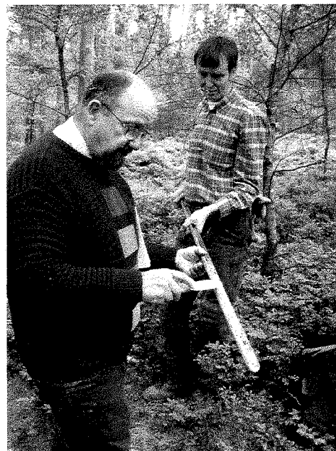
Mitarbeiter des Geologischen Dienstes beurteilen die Bodeneigenschaften am Bohrstock
